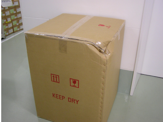
外装梱包状態 強制破壊試験後 After the Test---Outside of Package
