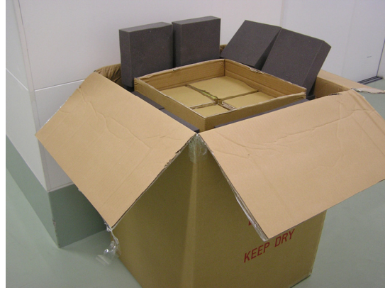
内外装梱包状態 強制破壊試験後 After the Test---Inside of package
