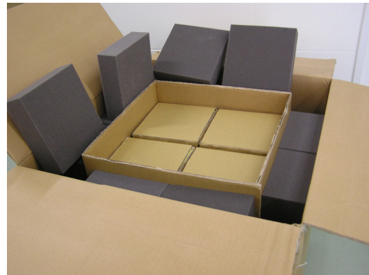
(Inside of Package---After the Test) 内外装梱包状態 落下試験後
