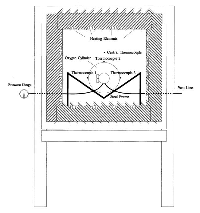
FIGURE 1. TEST FURNACE
