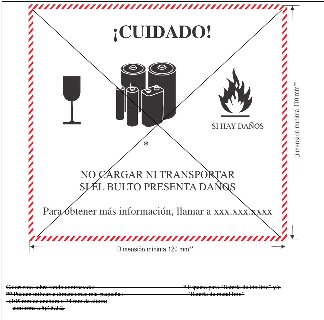
**Figura 5-32. Etiqueta de manipulación de baterías de litio**
