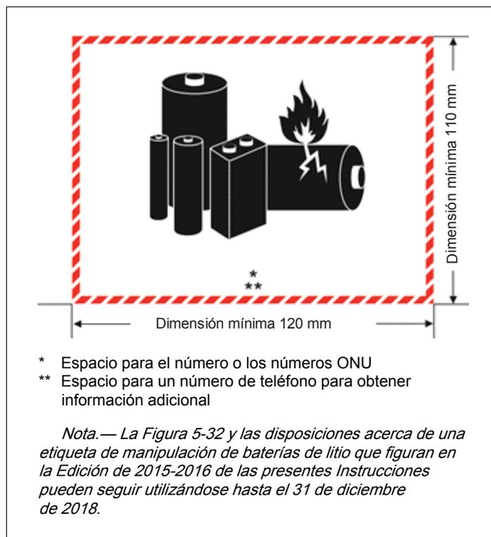
**Figura 5-3. Marca para las baterías de litio**
