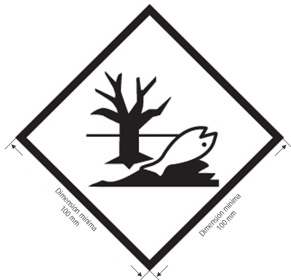
Figura 5-2. Símbolo convencional (pez y árbol): negro sobre blanco o fondo que contraste en forma adecuada
