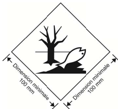
Figure 5-2. Signe conventionnel (poisson et arbre) : noir sur blanc ou sur fond assurant un contraste adéquat
