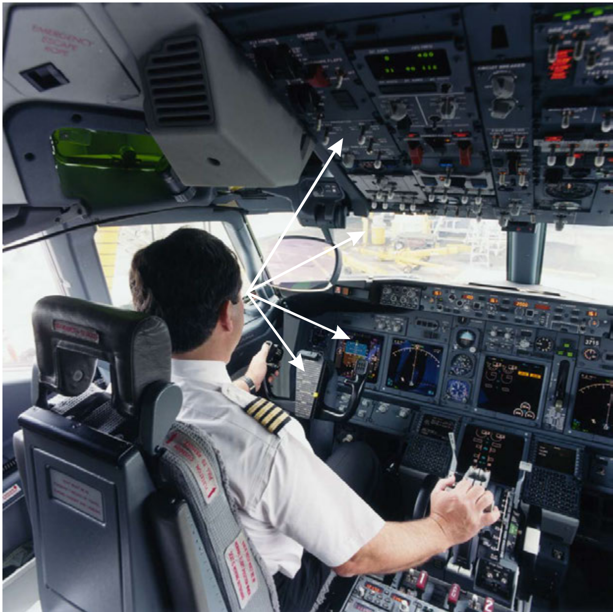
Рис. III-11-11. Зрительные расстояния в пилотской кабине
