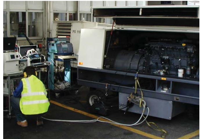
Mesures des émissions des moteurs d'un GPU
