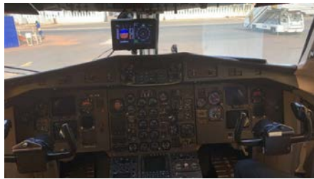
Figure 9: Poste de pilotage équipé pour le vol de démonstration d'un écran de navigation externe
