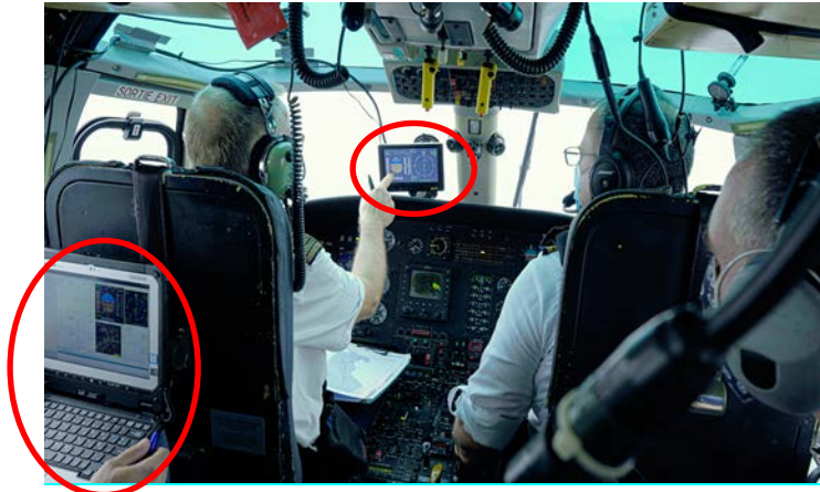
Figure 12: Poste de pilotage équipé pour le vol de démonstration d'un écran de navigation externe
