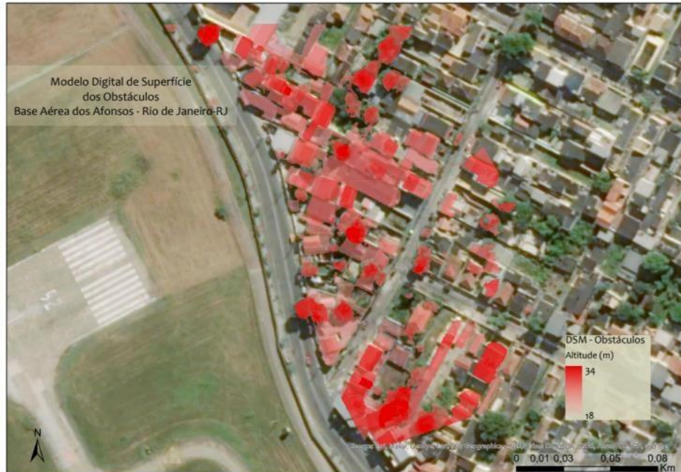
Figura 9: Modelo digital de superficie de obstáculos situados en la zona de aproximación del umbral 29 del aeródromo Campo Délio Jardim de Mattos (SBAF)
