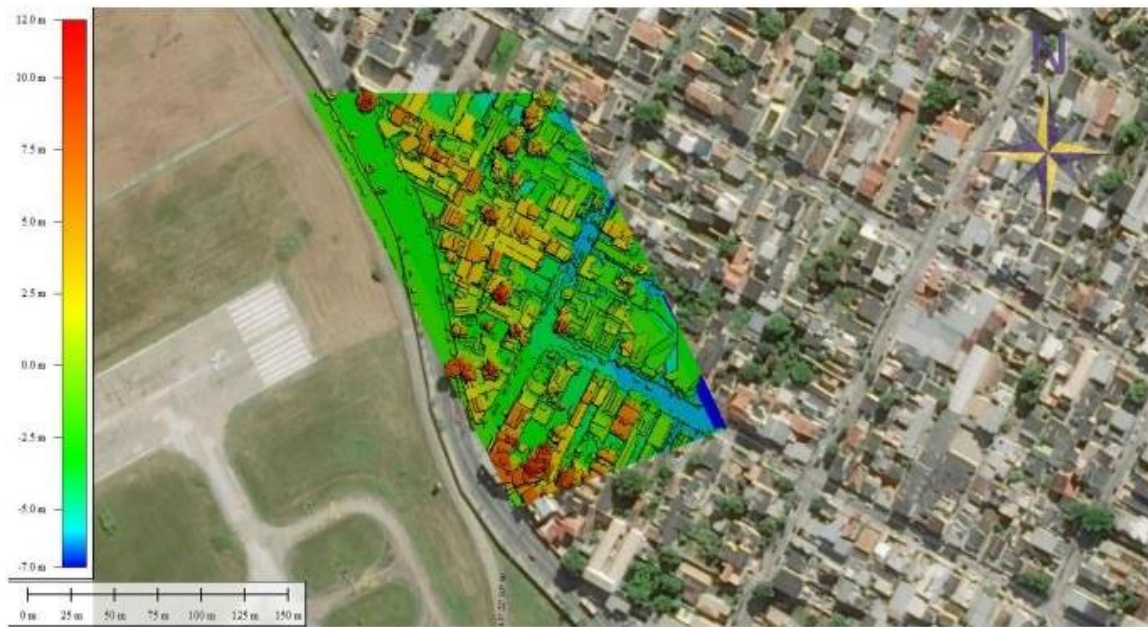
Figura 8: Geo-procesamiento entre imágenes de trama para verificar posibles obstáculos
