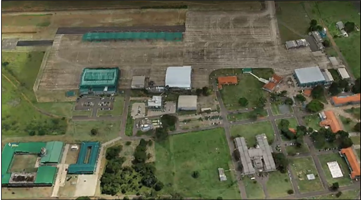
Figura 4 – Nube de puntos densificados a partir de la restitución proveniente de puntos densificados a partir de la restitución aerofotogramétrica con drones.
