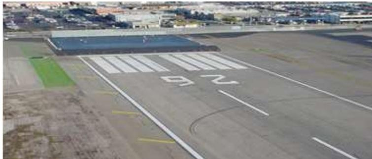
Figura 4. Foto aérea mostrando el Sistema de parada embebido original con materiales diseñados e instalado en la pista 26 en el aeropuerto Burbank, Burbank, California
