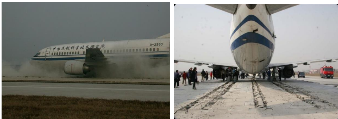
图1. 真机拦停试验
