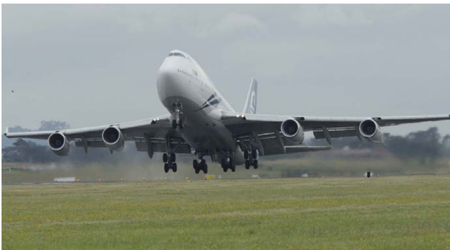
Боинг-747-400 с двигателями Rolls-Royce RB211, принадлежащий авиакомпании Air New Zealand, в декабре прошлого года вылетает из международного аэропорта Окленда. Один из четырех двигателей работает на смеси биотоплива второго поколения на основе ятрофы и обычного топлива Jet A1 в пропорции 50:50.
