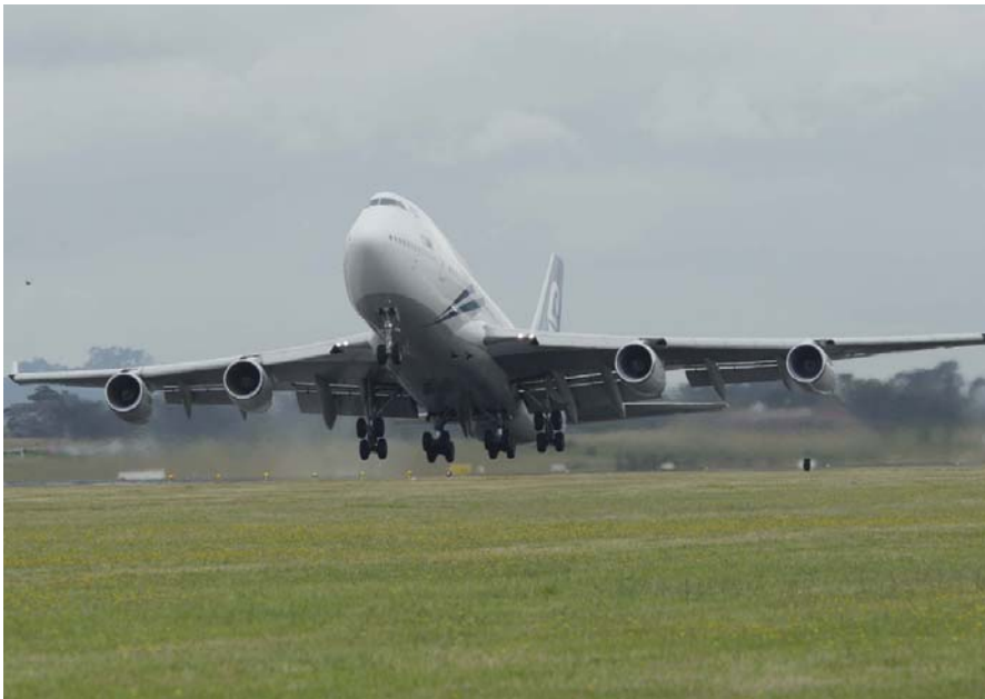
Un Boeing 747-400 d'Air New Zealand à turboréacteurs Rolls-Royce RB211 décollé en décembre dernier de l'aéroport international d'Auckland avec un de ses quatre réacteurs alimenté par un mélange moitié-moitié de biocarburant de deuxième génération au jatropa et de Jet A1.
