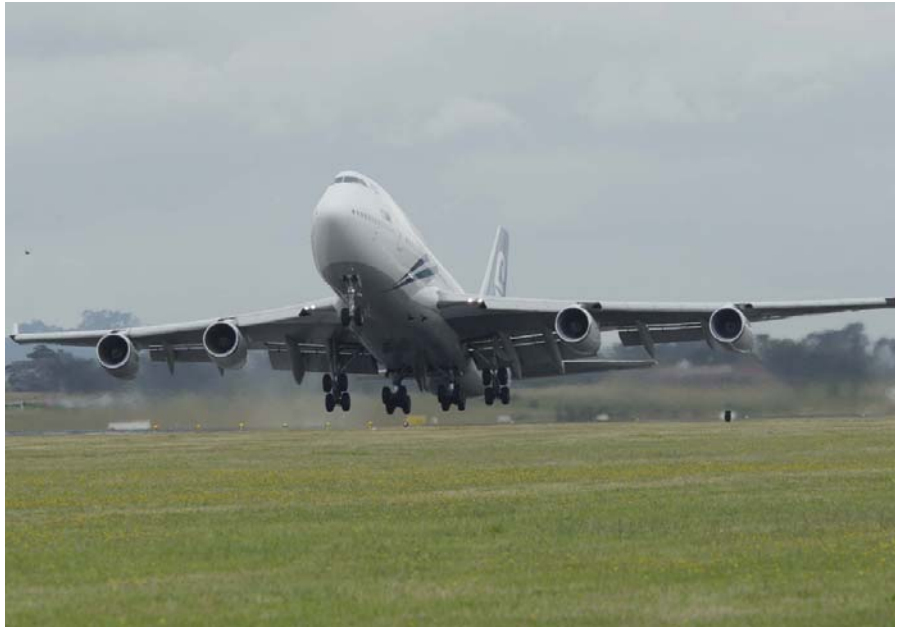
El Boeing 747-400 de Air New Zealand, impulsado por motores Rolls-Royce RB211 despegó del Aeropuerto internacional de Auckland en diciembre pasado. Uno de los cuatro motores funcionaba con una mezcla 50/50 de biocombustible de jatrofa de segunda generación y Jet A1.
