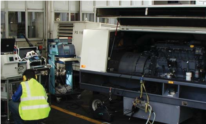
Измерение эмиссии выхлопных газов двигателя агрегата аэродромного питания
