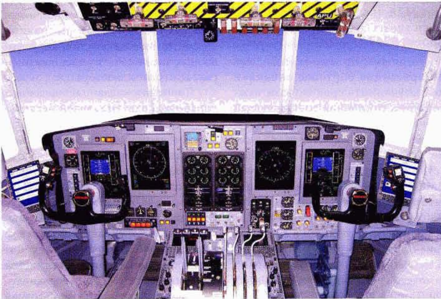
Вид приборной доски кабины экипажа гражданского транспортного самолета Lockheed L-100 правительства Дубая до и после недавно проведенной всеобъемлющей модернизации
