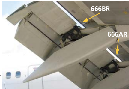
L'incident survenu au Boeing 757 s'est produit lors du premier vol suivant une révision majeure de 26 jours. On voit à gauche le volet extérieur droit, avec les emplacements des panneaux d'accès manquants 666AR/BR.
