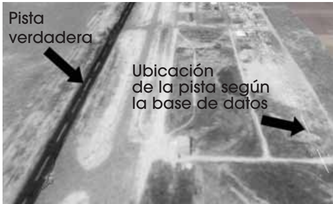
Figura 3. Un error en la manipulación de la base de datos puede provocar un desplazamiento considerable en la aproximación diseñada con respecto a la pista verdadera, como lo evidencia este ejemplo que muestra la pista 26 en Moriarty, New Mexico.
