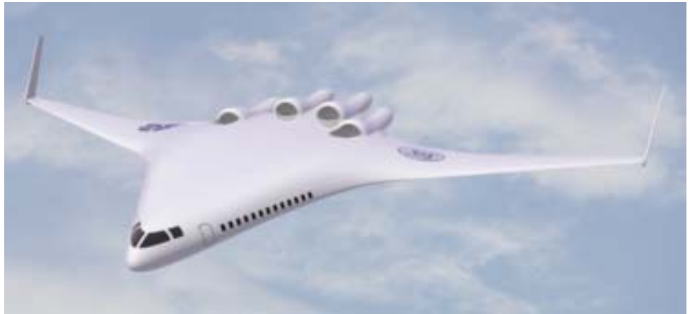
Ce rendu CAD du design d'un avion « silencieux » montre une configuration de la cellule et des moteurs radicalement différente des designs existants. Un design conceptuel final devrait être prêt pour être examiné par l'industrie à l'automne 2006.
