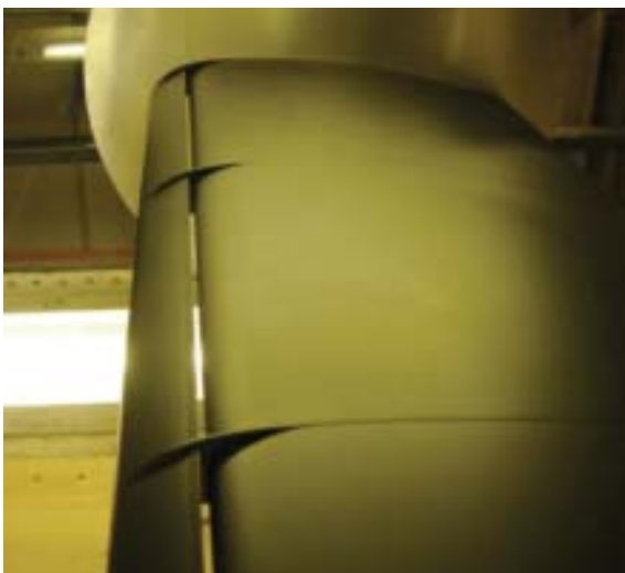
Dispositif hypersustentateur avec bords d'attaque conventionnel, en soufflerie pour une évaluation du bruit.
