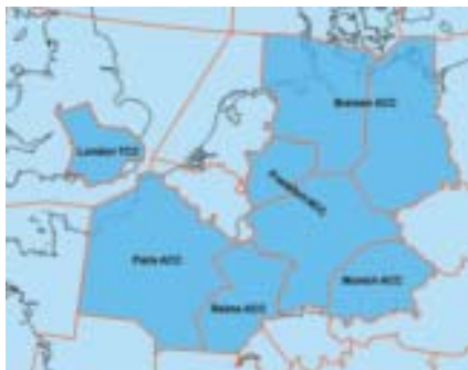
Figure 2. Zone de couverture EHS mode S prévue à l'horizon 2008, pour l'espace aérien inférieur (à gauche) et l'espace aérien supérieur.
