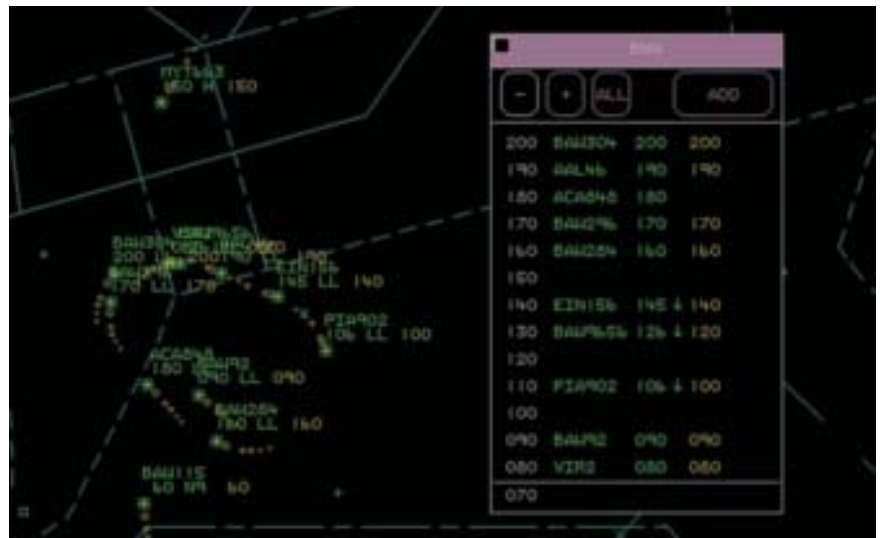
Figure 3. Un nouvel outil pour la gestion des circuits d'attente des aéronefs utilise les paramètres avion descendants dans l'environnement EHS.
