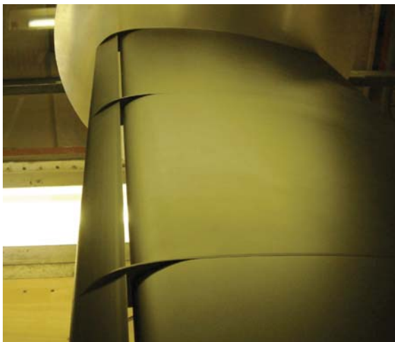
Aleta de ala básica (convencional) y sistema de alta sustentación instalados en un túnel de viento para evaluación del ruido.
