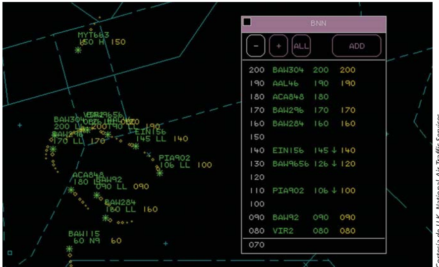
Figura 3. Una nueva función para el manejo de los circuitos de espera de las aeronaves utiliza parámetros de las mismas transmitidos en enlace descendente en el entorno EHS.
