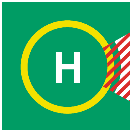
Figura 5-57. Señal de sector de aterrizaje prohibido en la heliplataforma
