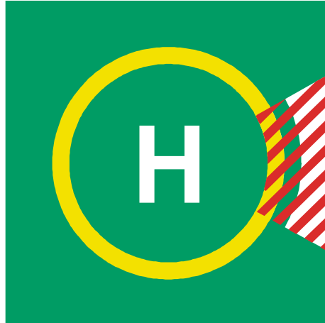
Figura 5-57. Señal de sector de aterrizaje prohibido en la heliplatформа
