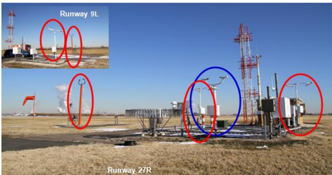
Figura 1. Estrecha proximidad de sensores en el aeródromo KPHL. Los óvalos rojos son sensores de visibilidad; el óvalo azul es un sensor de condiciones meteorológicas presentes. Con las tecnologías actuales, todo puede ser consolidado, brindando, al mismo tiempo, mayor redundancia.
