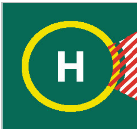
Figura 5-5. Señal de sector de aterrizaje prohibido en la heliplataforma
