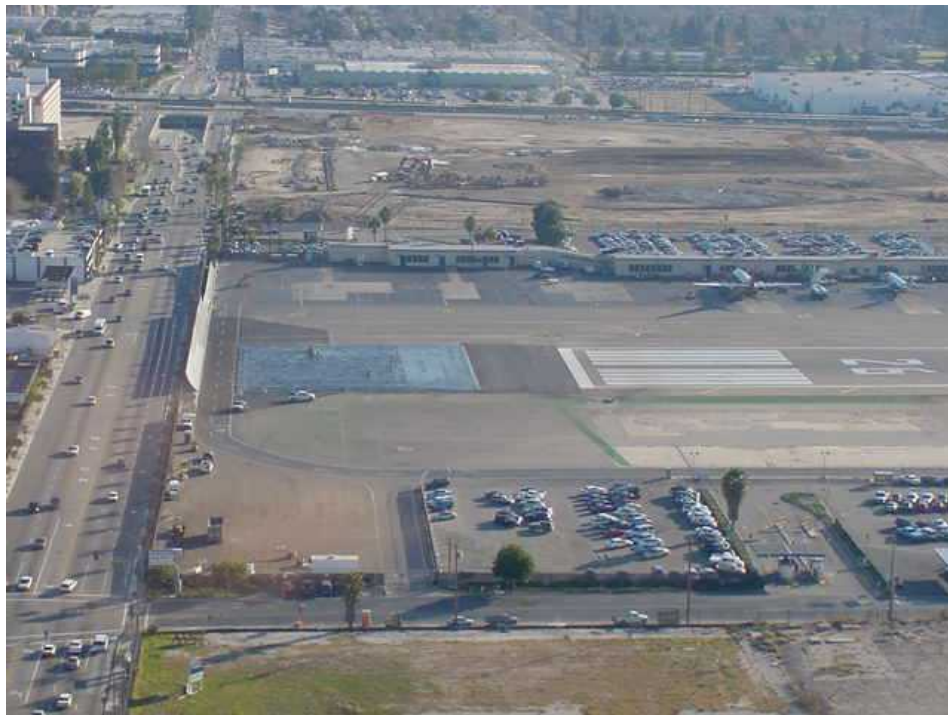
Figura 6 – Fotografía aérea que muestra (a) la relación de Hollywood Blvd. a la salida de la Pista 26 en el Aeropuerto Burbank, en Burbank, California, y (b) la instalación EMAS esperando la colocación de las señales en forma de flecha
