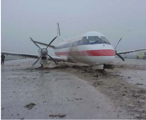
Figura 5 – Fotografías de EMAS a la salida de la Pista 22L en JFK, tomadas al día siguiente en que ocurrió la detención segura de un aterrizaje largo de un SAAB-340 en junio de 1999 (nótese el área de superficie que se retiró para extraer a la aeronave)
