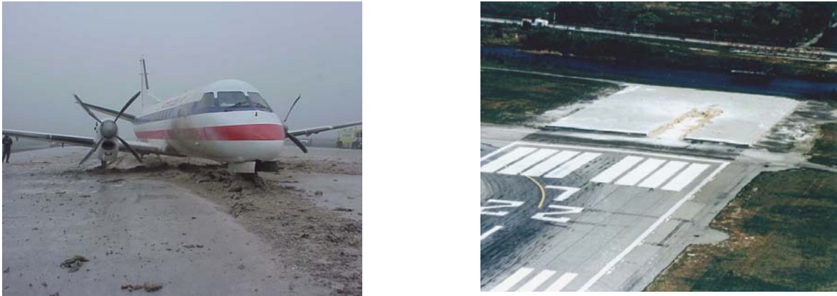
Figura 5 – Fotografías de EMAS colocado al final de la Pista 22L en JFK, tomadas al día siguiente en que un SAAB-340 se detuvo en forma segura luego de un aterrizaje largo en junio de 1999 (observe el área superficial que fue retirada para sacar a la aeronave)
