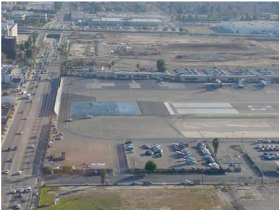
Figura 6 – Foto aérea que muestra (a) la relación entre el Bulevar Hollywood frente a la Pista 26 en el Aeropuerto de Burbank, Burbank, California, y (b) la instalación EMAS que aún no le han colocado las señales en forma de V
