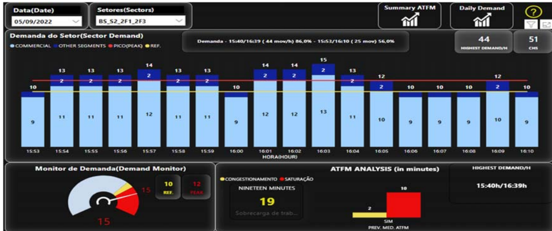
Figura 2 – Monitoreo estratégico de la demanda para sectores ATC del Espacio Aéreo Brasileño.
