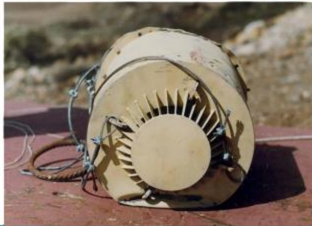
Después de la caída de 9 m
