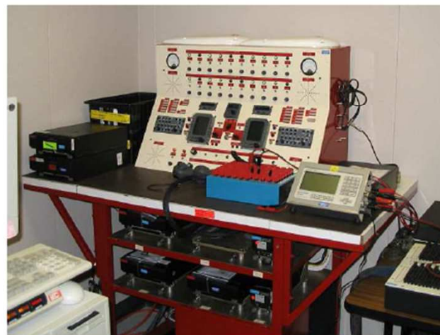
Figura 8. Bancada Primus II (Radio Navegação)
