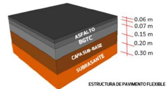
ESTRUCTURA DE PAVIMENTO FLEXIBLE
