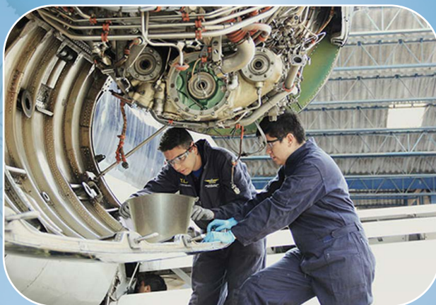
Personal de mantenimiento de aeronave identifica evidencias de impacto con fauna
