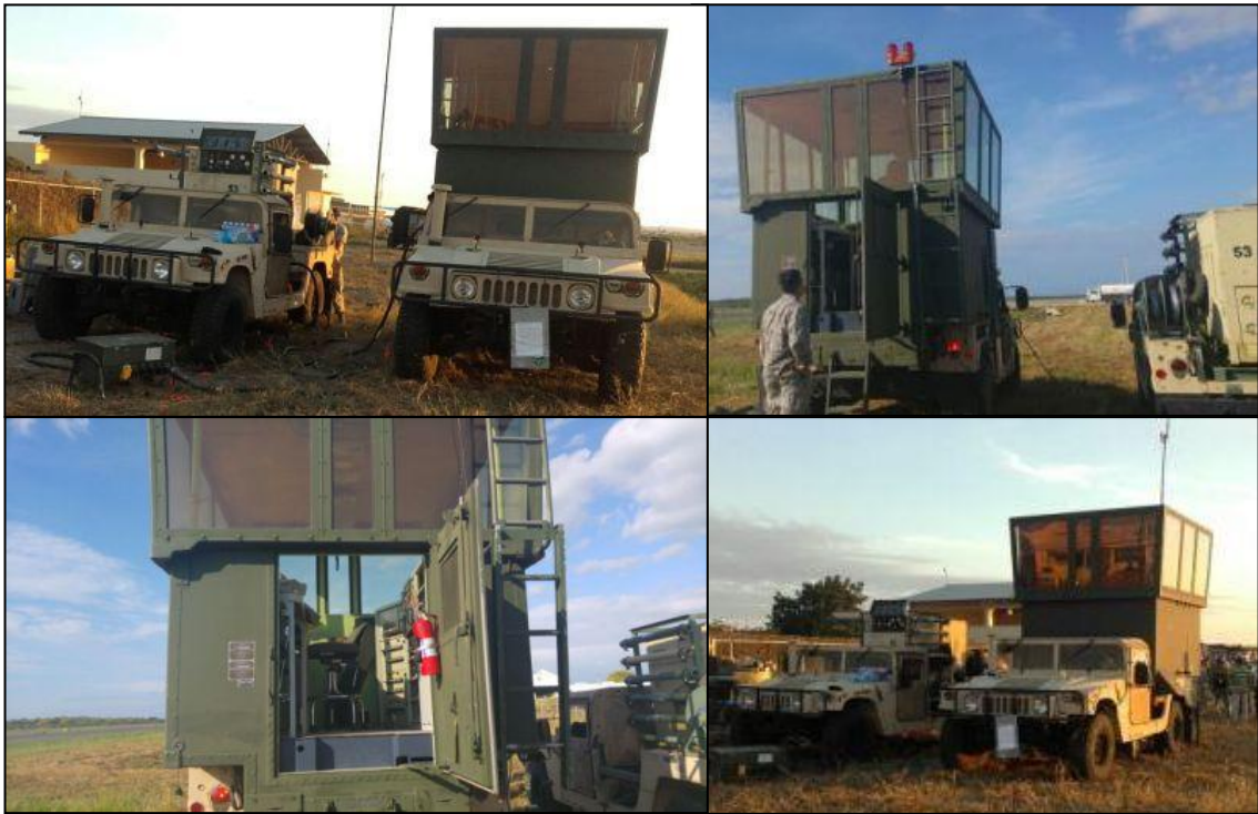
Torre de control móvil provista por las Fuerzas Armadas de Estados Unidos
