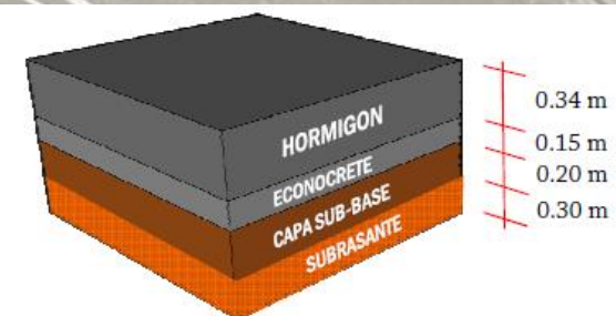
ESTRUCTURA DE PAVIMENTO RÍGIDO
