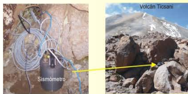
Figura 2. El sismómetro, es el equipo utilizado para la vigilancia sísmica del volcán, son de diferentes modelos y tamaños. Se instalan alrededor del volcán.
