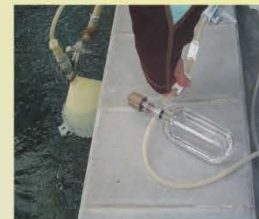
Figura 9. Muestreo de gases que burbujan en las fuentes termales para su análisis químico, con la botella de Giggenbach. Fuente: Fuente termal Jesús.
