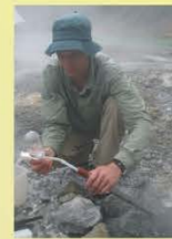
Figura 7. Medición de la concentración de los gases de las fumarolas volcánicas en el cráter del volcán, con la botella de Giggenbach.
