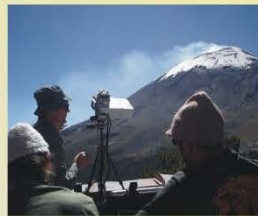
Figura 6. Medición de la concentración del gas SO 2 (dióxido de azufre) en las fumarolas volcánicas, con el espectroscopio de absorción Minidiox.
