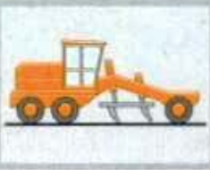
Corregir el perfil de la mezcla extendida
