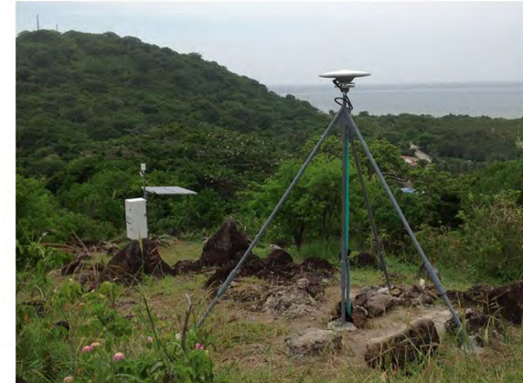
Estación GNSS/MET Isla de Providencia. Proyectos COCONET-GEORED, 2012 UNAVCO/NSF – Servicio Geológico Colombiano
