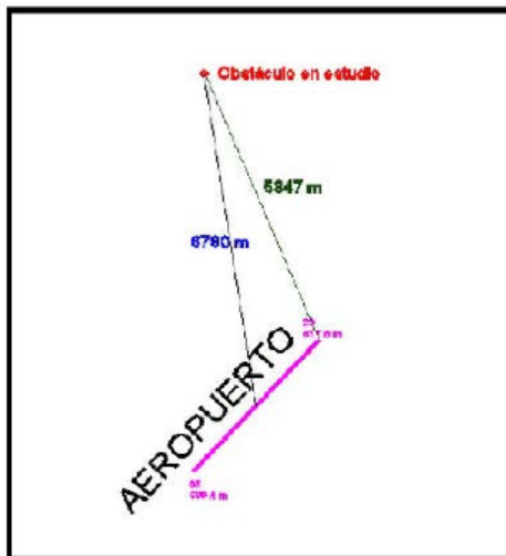
Ejemplo de esquema en planta del obstáculo que se pretende construir.
