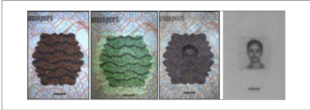
الشكل ج-٦ الجواز (HUN, P, 1, 2006): حبر متغير بصرياً ذو طابع شخصي يرى من زاويتين مختلفتين في الضوء النافذ وفي الضوء تحت الأحمر
