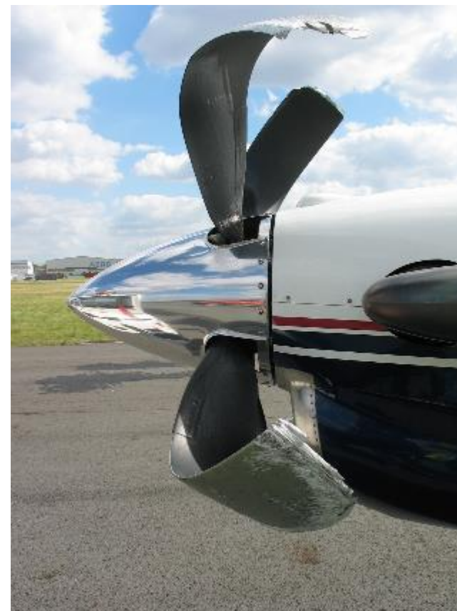
Déformation de l'hélice « en moustache »
