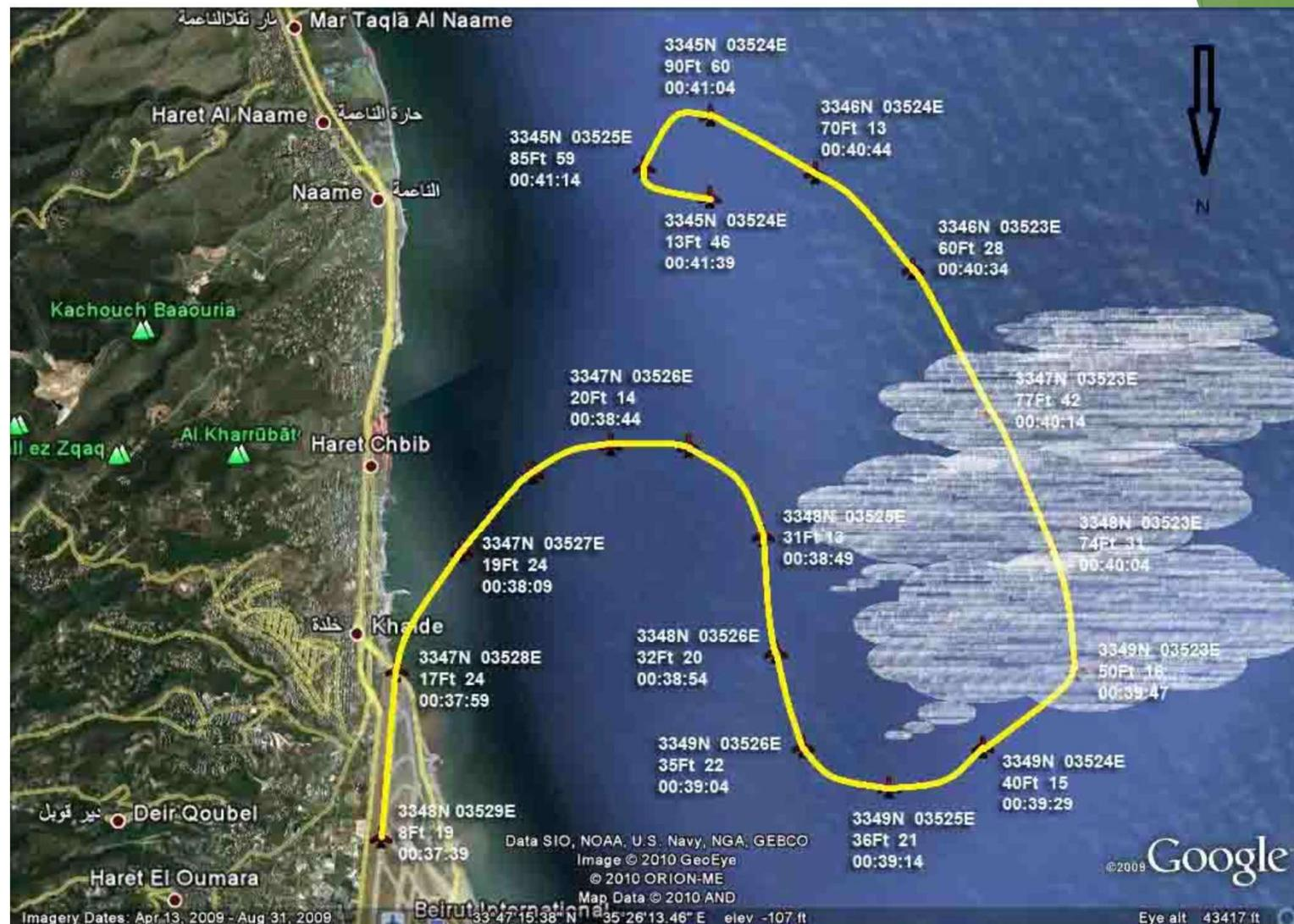
**Evaluation position estimée du point d'impact à partir de la trajectographie radar du contrôle aérien.**
