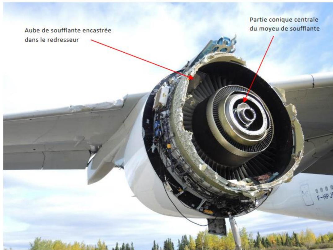
Figure 4 : Moteur N°4 endommagé du F-HPJE à Goose-Bay
