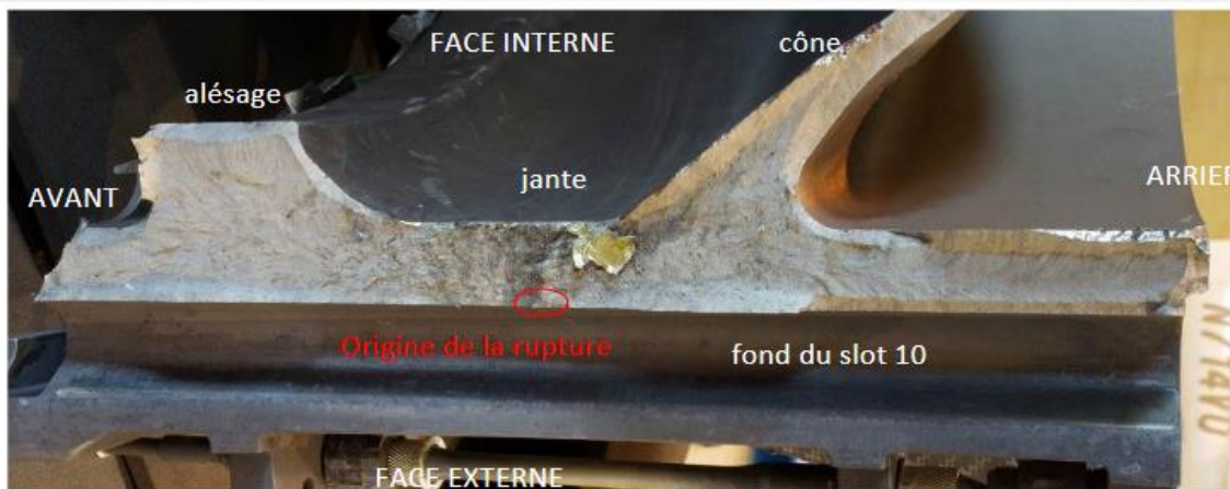
Figure 17 : Surface de rupture de l'alvéole n°10
