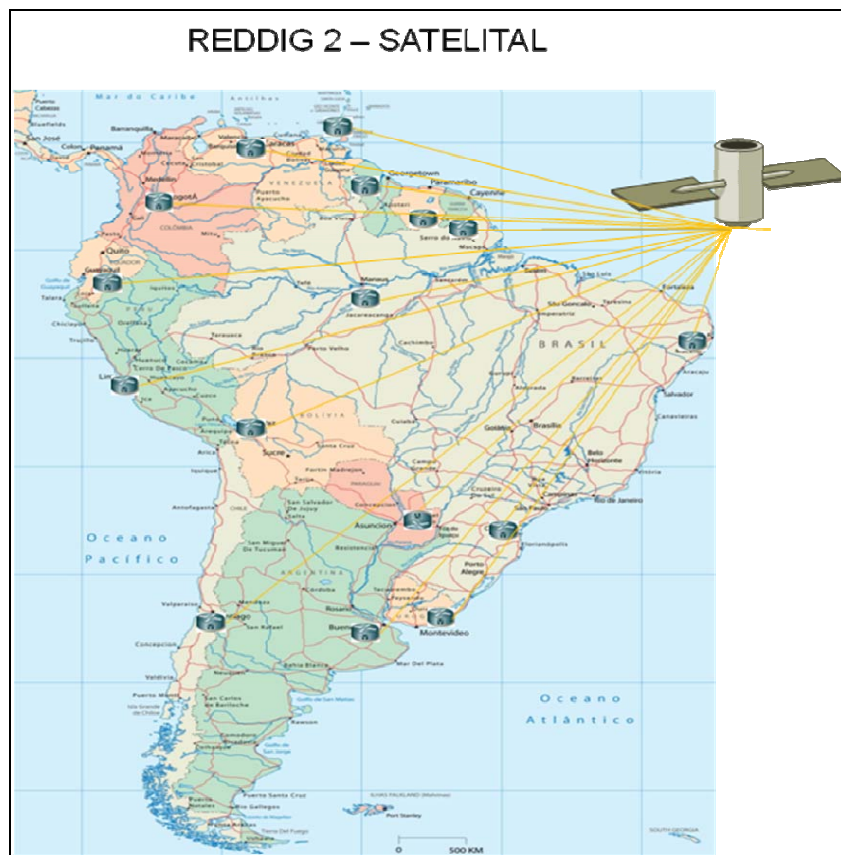
Figura 3-1: Esquema REDDIG satelital
