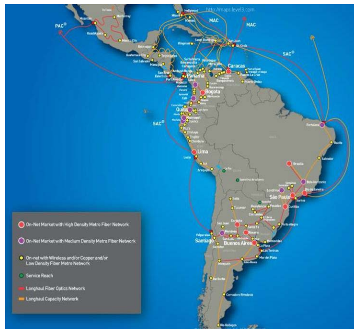
Figura 4: Red terrestre de fibra óptica de LEVEL 3
