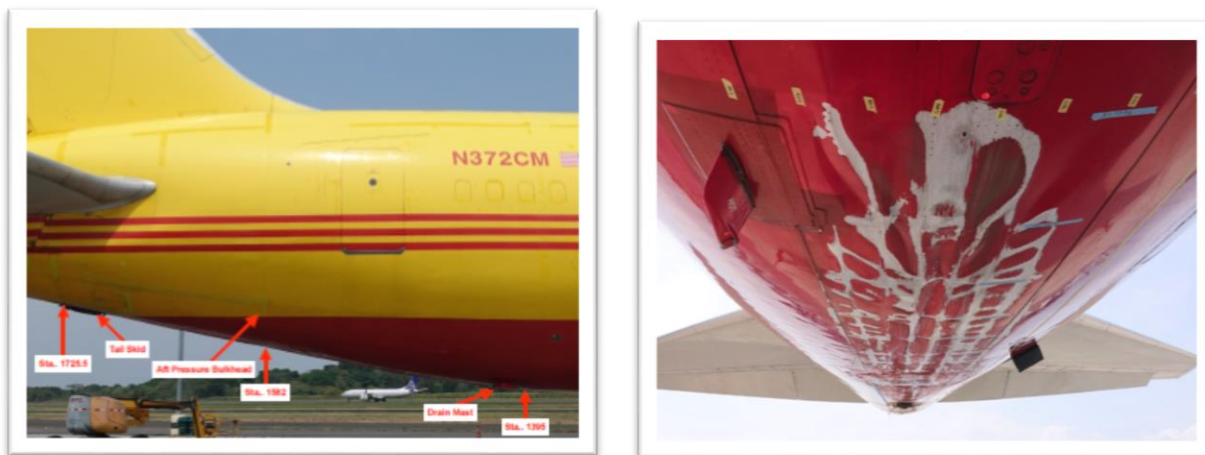
Figura No.2, 3 – Daños en la parte inferior trasera del fuselaje.
