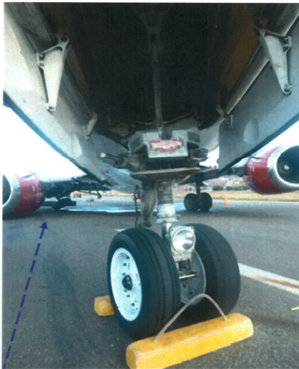
Colapso de Tren Principal Derecho
