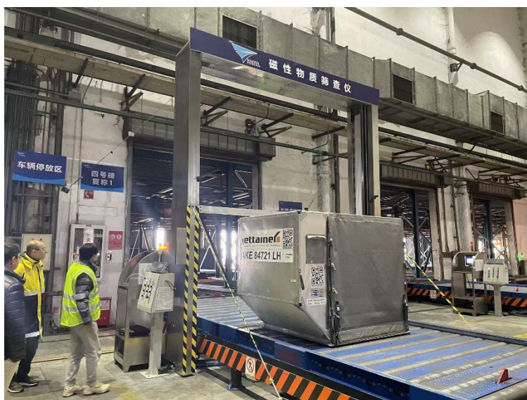
图 1. 大型货库弱磁性物质快速检测设备应用现场
