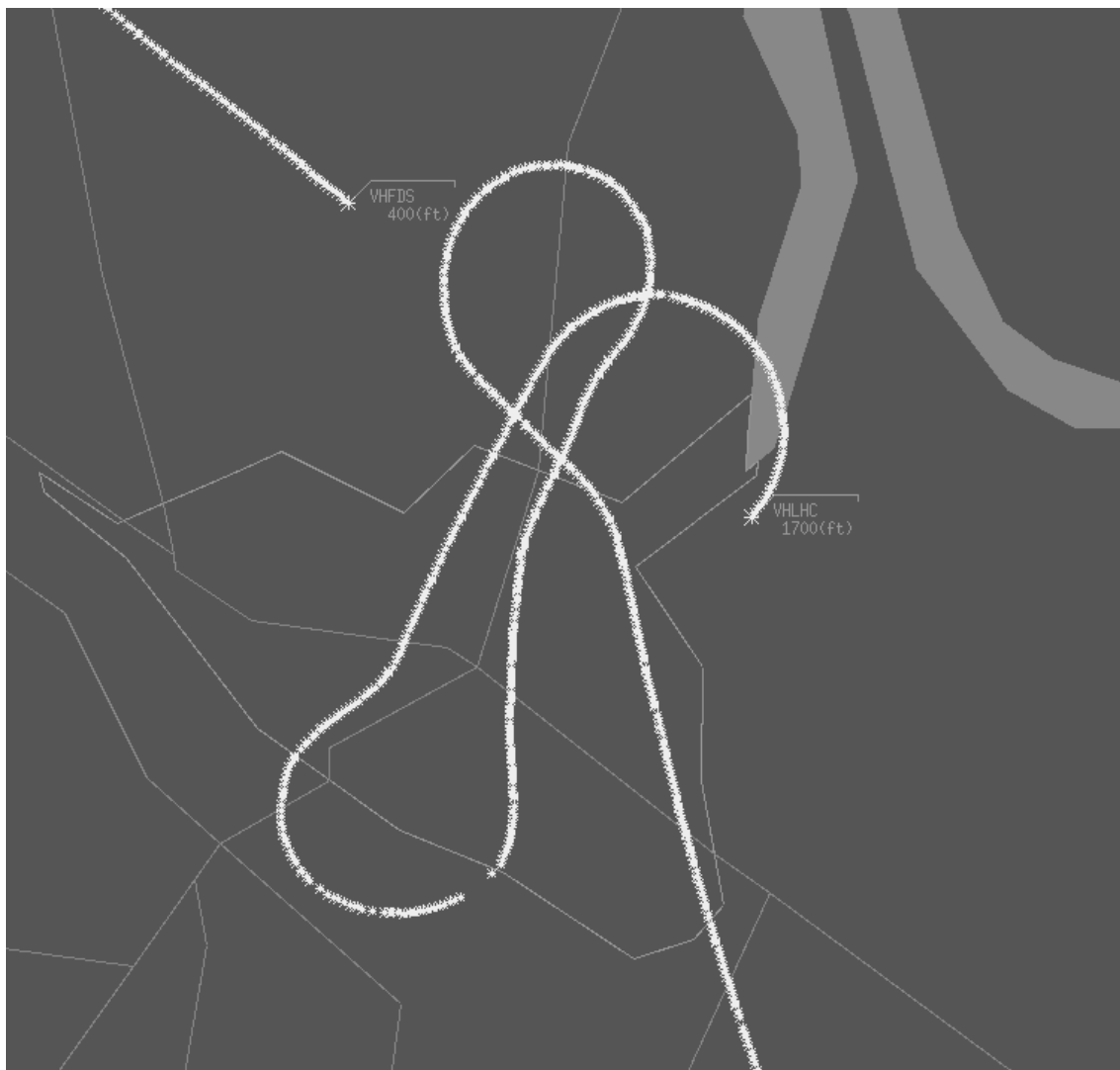
Рис. 1. Два воздушных судна, оснащенных ADS-B, на расстоянии 60 м. миль от наземной станции ADS-B
