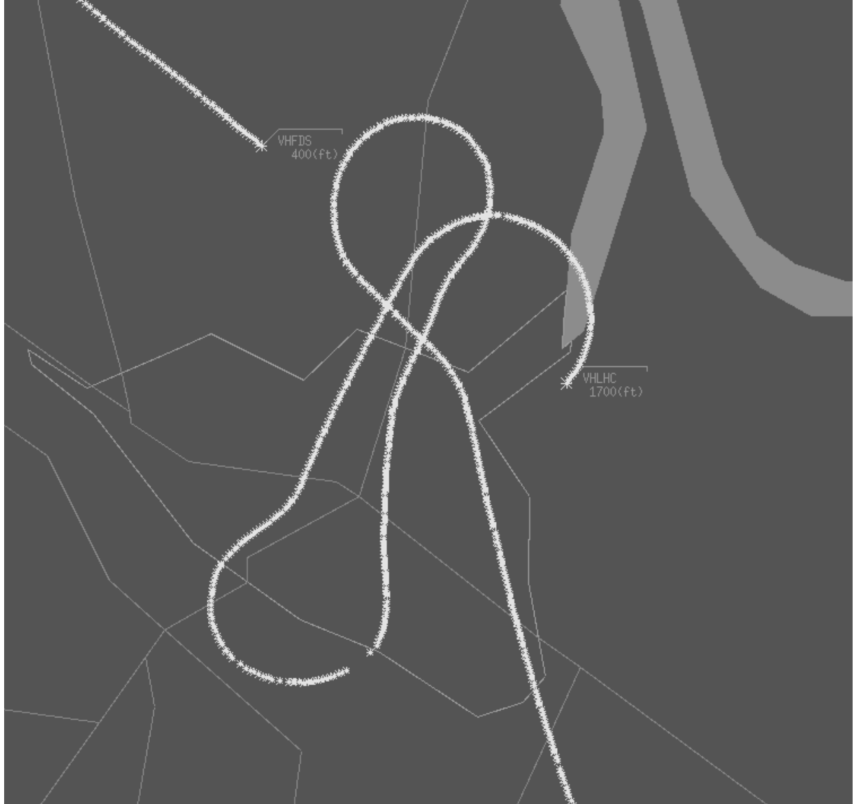
الشكل ١ - طائرتان يعرضهما الاستطلاع التابع التلقائي ADS-B من مسافة ٦٠ ميلا بحريا من محطة أرضية للاستطلاع ADS-B
